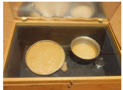
Die Sonnenstrahlen liefern die Energie, um Kuchen innert 1 Stunde und 20 Minuten zu backen.
